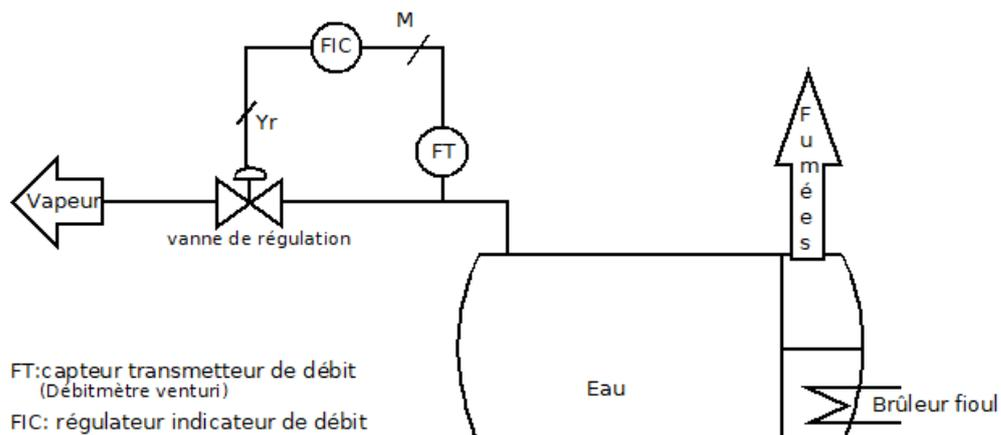
La mesure du débit de vapeur (régulé à  $2000 \text{ kg}\cdot\text{h}^{-1}$ ) est réalisée par un débitmètre Venturi intégré à la canalisation reliant la chaudière au caisson.
