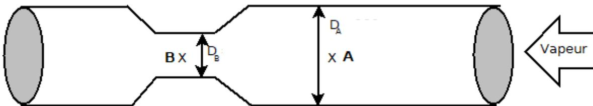
Dans cette étude réalisée en régime permanent, on considère la masse volumique de la vapeur d'eau constante ( $\rho = 1,11 \text{ kg}\cdot\text{m}^{-3}$ ). Les points A et B sont à la même altitude.
