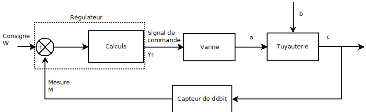
Pour le réglage du régulateur, on envisage une régulation continue avec un correcteur P ou PI.
