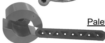
Ici, la pompe à vide fonctionne en créant, dans un circuit fermé, une dépression de **0.7 bar**. L'axe de la pompe à vide mécanique est entraîné par l'arbre à cames du moteur, qui **tourne 2 fois moins vite que le vilebrequin**. La rotation de l'axe entraîne une palette qui permet le cycle de pompage – refoulement : admission – échappement.
