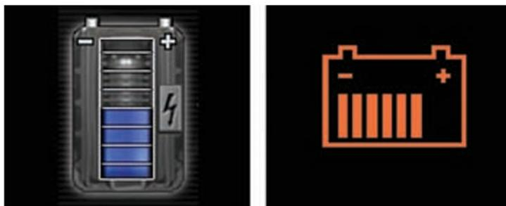
Pour préserver la durée de vie de la batterie, le niveau de charge ne descend jamais en dessous d'un seuil de 20% de charge, même si le niveau est affiché à 0 barrette après un roulage ZEV.
